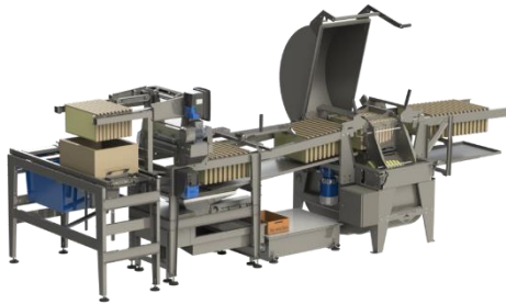
Slyngelinje med deboxer, skrellemaskin, voksskrue, tavlestativ og horisontalslynge og sump
