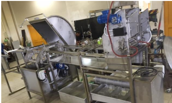
Königin slyngelinje med automatisk skrellemaskin og horisontalslynge med voks-skrue og sump
